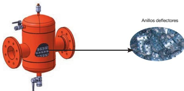
Los compensadores o agujas hidráulicas son colectores donde confluyen y se mezclan los flujos de caudal de varios circuitos de calefacción o refrigeración.
