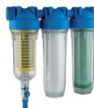
Filtro autolimpiante con grado de filtración de 90 micras, una filtración posterior a 25 micrones y un tratamiento final con carbón activo capaz de eliminar olores y colores que el agua de lluvia asume en el camino hasta tanque de acumulación. La unidad de tres etapas es fabricado en un solo contenedor triple.
