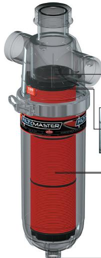
■ Los filtros hidrociclónicos Filtmaster, realizan una decantación de las partículas sólidas en suspensión en el fluido.
