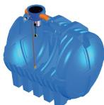
El sistema está equipado con un tanque de almacenamiento de polietileno alta densidad lineal, con boca de entrada de agua y alivadero de PVC, tapas de registro para inspección y limpieza, tubería de succión con válvula de pie.
