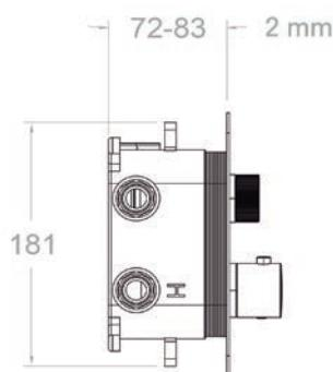
Box completamente estanco y evita filtraciones de agua en el interior de la pared. Puede ser instalada en cualquier tipo de pared, por ejemplo, pladur o standard.
