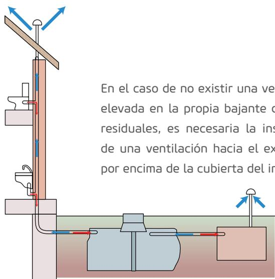
En el caso de no existir una ventilación elevada en la propia bajante de aguas residuales, es necesaria la instalación de una ventilación hacia el exterior, y por encima de la cubierta del inmueble.
